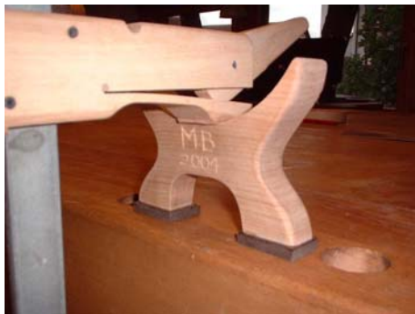
Die Sohlen sind angeleimt
