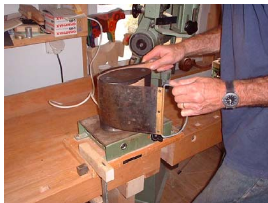
Ein Ring wird am heißen Eisen gebogen...
