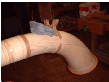
Der grundierte Becher wird mit Stahlwatte abgerieben
