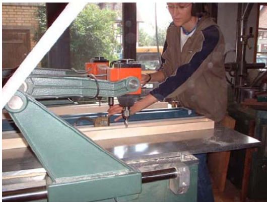
Die Rohre werden ausgehöhlt
