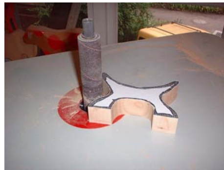
Das Füßchen wird geschliffen
