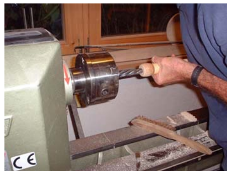
Das Loch im Fässchen passt man für das Mundstück an
