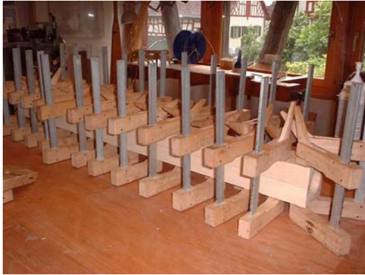
Rohr geleimt und gepresst
