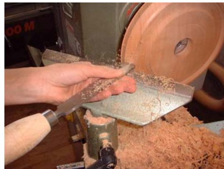
Drechselarbeit am Becherring
