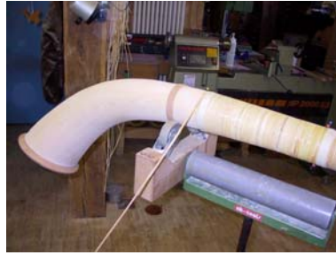
Es wird bis zum ersten Ring gewickelt
